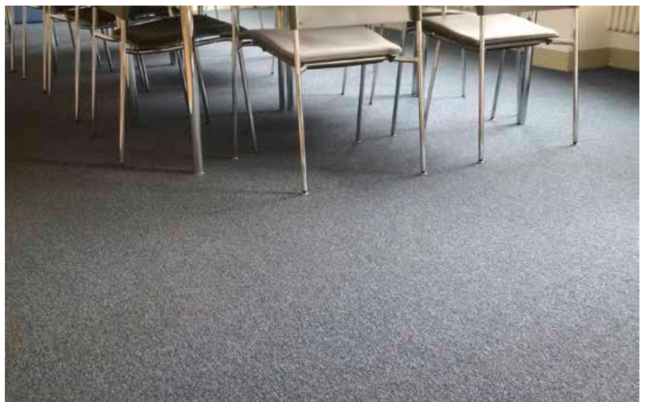
Textile Bodenbeläge verhindern Druckstellen von Möbeln und haben eine trittschalldämmende Wirkung.
